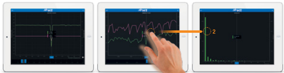
Zoom sobre una caída de tensión y corriente.
